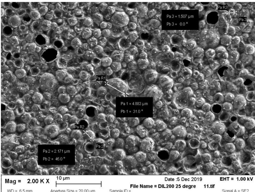
Microscopie électronique à balayage d'un échantillon de formulation micro encapsulée de la phéromone contre le ver de la grappe - *Crédit photo @M2i*
